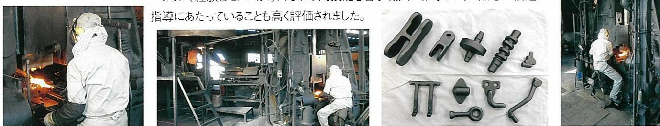
高温に加熱された材料が冷える前に、的確にハンマーで打撃を与え金型に打ち込み成形するハンマー型鍛造には、気温や風など環境の変化とともに材料の状況を体で感じ取る能力が求められます。鈴木さんは、微妙な変化を感じとり、材料を正確に成形するために油と空気の供給量やハンマーを打ち込むタイミングや強さを調整し、一つ一つていねいに製品を作り上げています。
